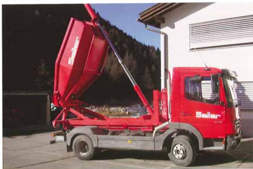
Unser Mercedes 918 mit der extra konstruierten Hochkipmulde
