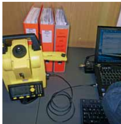
Der Theodolit wurde auf der Baustelle via Laptop mit den nötigen Absteckungspunkten vorbereitet, die genauen Punkte, bzw. Landes Koordinaten erhielten wir vom Ingenieur.
