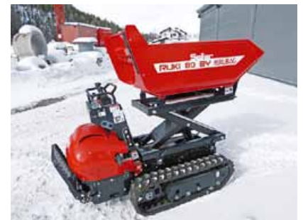
Die Motorkarrette verfügt über eine höhenverstellbare Mulde
