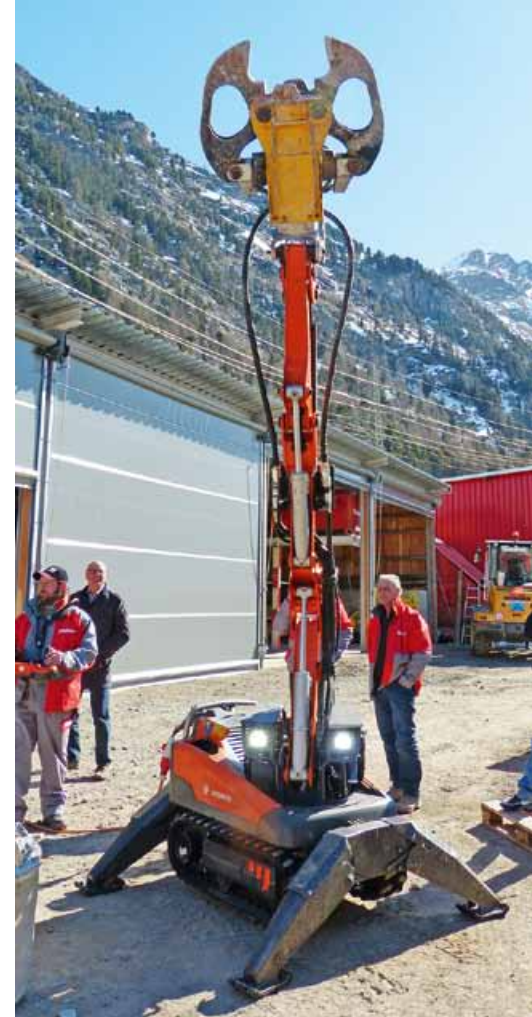
Der Abbauroboter der beissen, graben und spitzen kann. Abbildung mit Beisszange, welche einen Druck von 32 Tonnen entwickelt. Dies alles mit elektrischem Antrieb.
