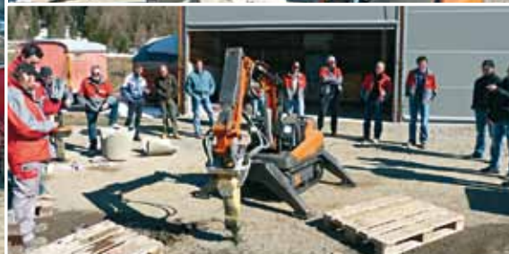
Der Abbauroboter faszinierte. Einmal mit Betonbeisszange und einmal mit Abbauhämmer.
