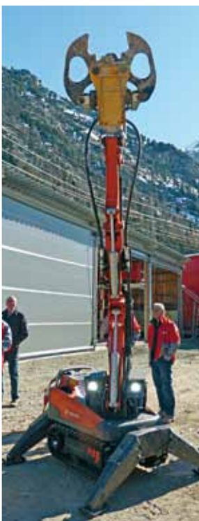
Der Abbauroboter faszinierte. Einmal mit Betonbeisszange und einmal mit Abbauhämmer.
