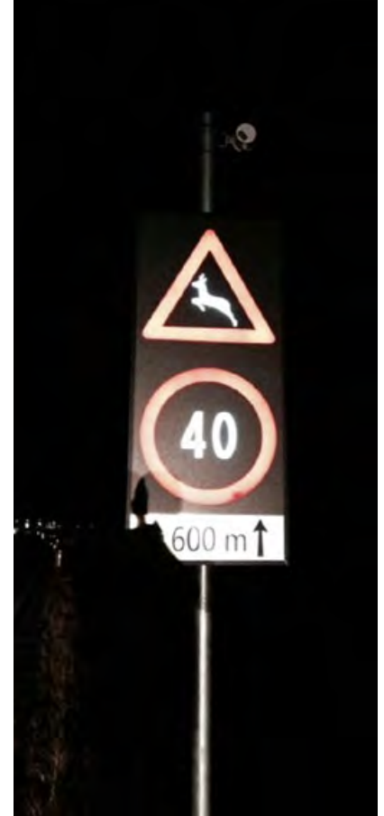
Das Aufblinken aller 6 Signale, weist auf Wild innerhalb eines Streifens von 5-6m neben der Fahrbahn hin
