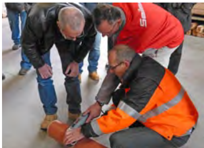
Mit der richtigen Maschine kann in einem Arbeitsgang geschnitten und angefast werden
