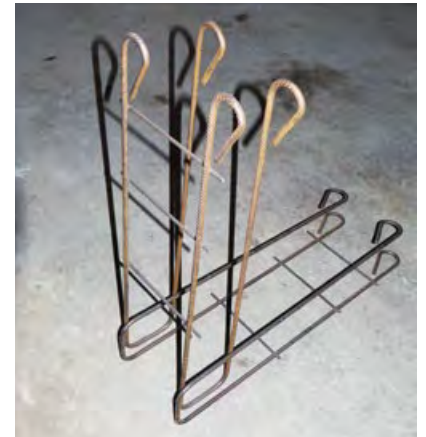
Ein Dauerthema sind die Anschlusseisen. Hier die Lösung, wie wir sie gerne hätten, doch nicht alle Ingenieure sehen das so.
