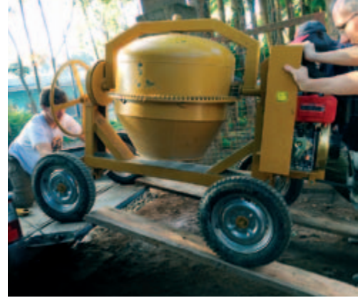
Kuhstallerweiterung: betonieren der Bodenplatte. Der Sand musste zuerst mit dem sehr groben Kies gemischt werden, nach kurzer Zeit gaben wir auf und kauften einen Betonmischer.
