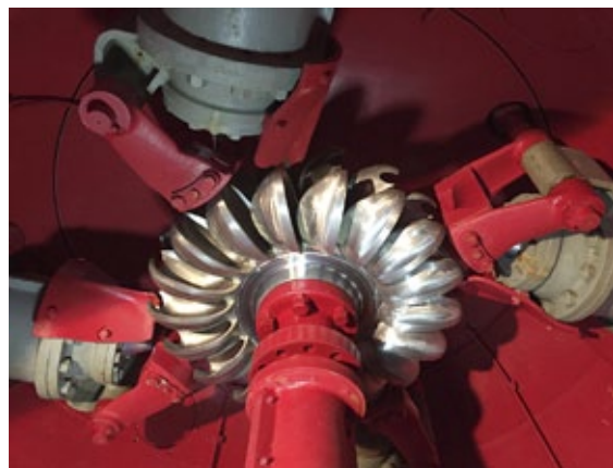
Die gleiche Turbine von unten mit den vier Einspritzdüsen.
