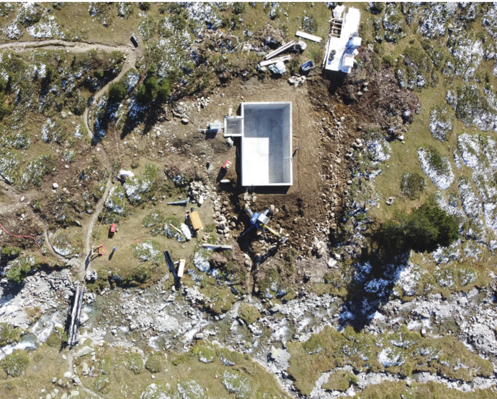
Hier sind die Wasserfassung, die Zuleitung und die Becken gut zu erkennen.
